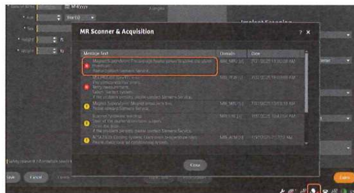
Рисунк 1 — Повідомлення про помилку: «Magnet Supervision: The average heater power is above the alarm threshold. Please contact Siemens Healthineers Service.» (Контроль магніту: середня потужність нагрівача перевищує порогове значення попередження. Зверніться до сервісного центру компанії Siemens Healthineers).
